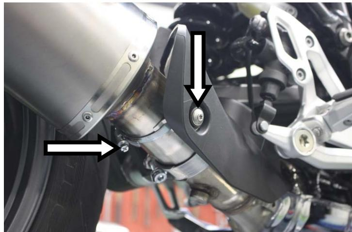
**IT** · Fissare la protezione mediante vite originale e serrare definitivamente la fascetta
