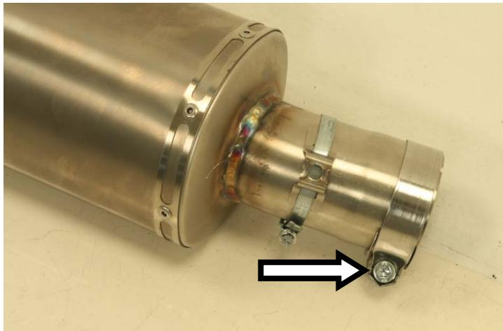
**IT** · Montare senza serrare completamente la fascetta nell'innesto del terminale
