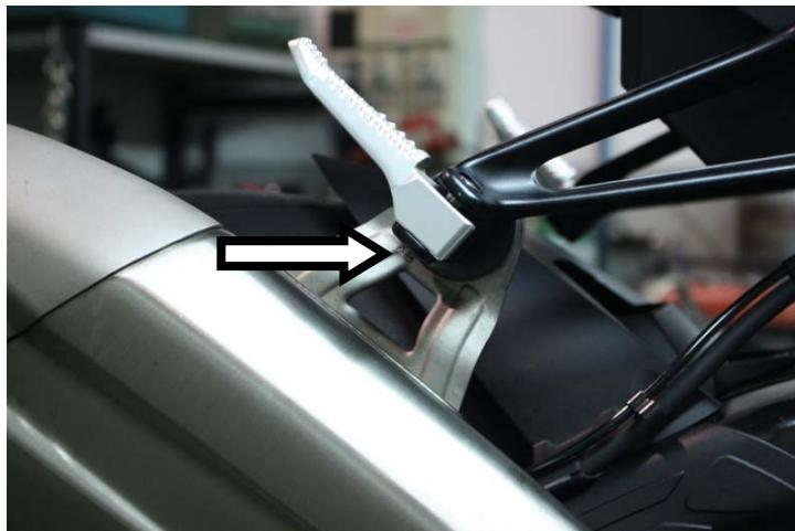
**IT** · Solo per il montaggio dei terminali Arrow: Togliere il fermo, sfilare il perno e rimuovere il pedalino
