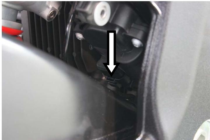
**IT** · Scollegare il cablaggio del motore attuatore valvola
