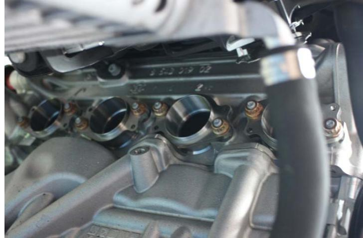
**IT** · Fissare boccole e flange ai prigionieri dei cilindri come indicato in foto (controllare che le guarnizioni siano correttamente posizionate nelle loro sedi)
